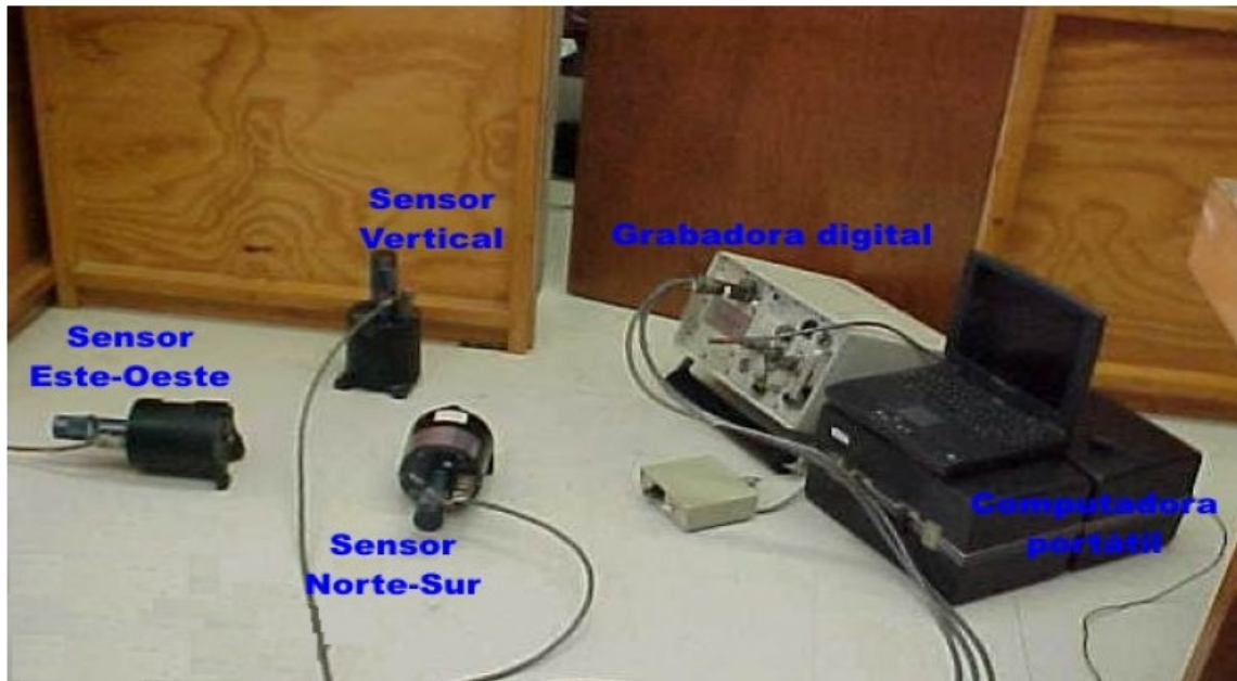
Figura 9. Configuración típica del equipo sismológico empleado en el registro de microtremores, para la medición de los periodos dominantes del suelo, en Tijuana, B.C.
