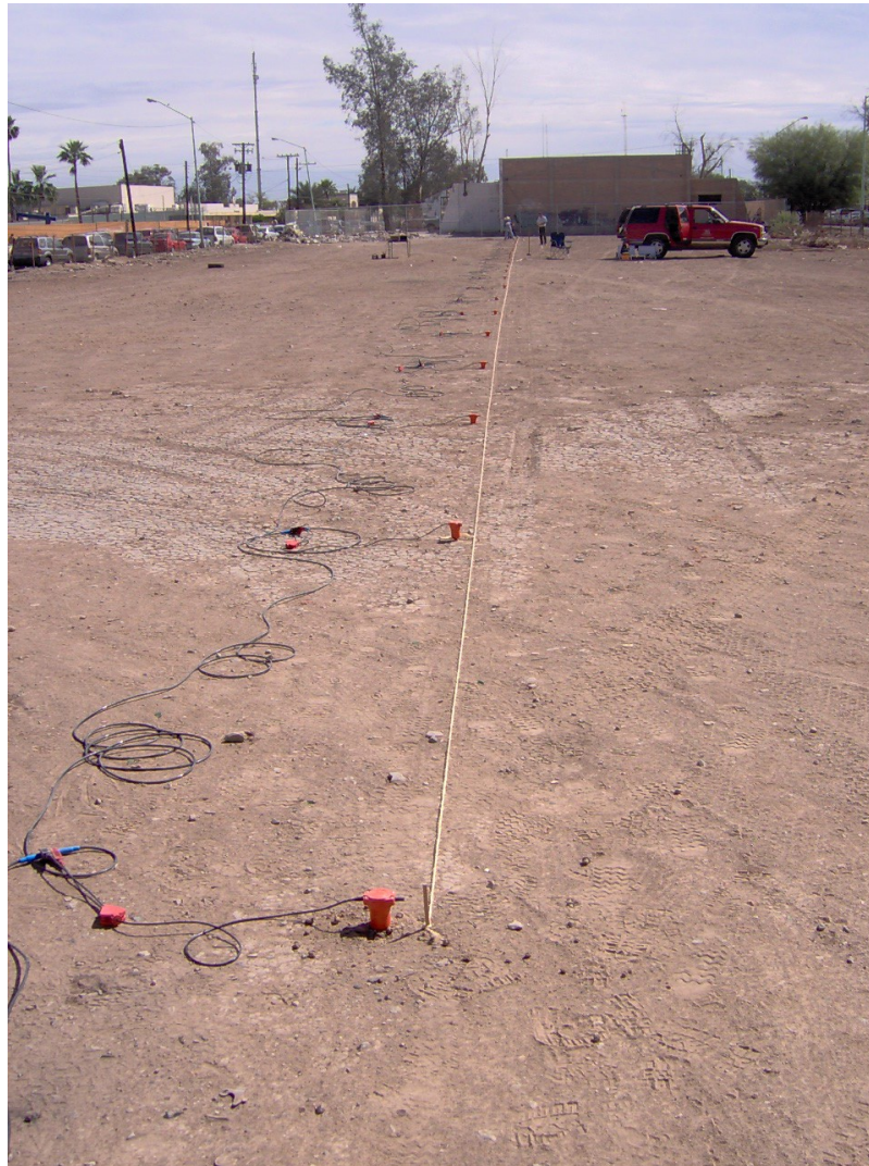
Figura 11. Ilustración de la configuración del perfil lineal, con 24 sensores verticales, para el registro de microtremores.
