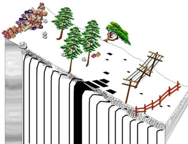
Figura 8. Movimiento de ladera con una velocidad tan lenta (reptación del terreno) que pasa desapercibido por el ser humano. Solo la visión de un geólogo e instrumentos apropiados son capaces de detectar y cuantificar su avance.
